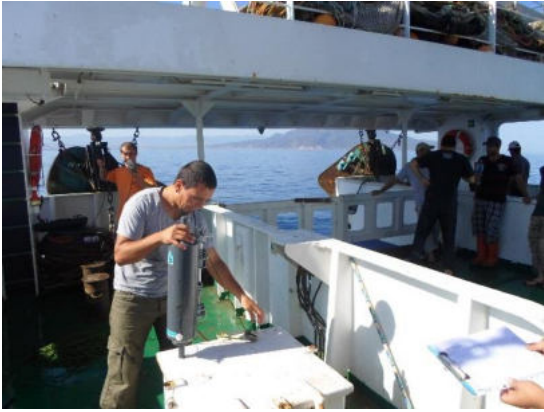
Figure 10 : Prélèvement d'eau par bouteille Niskin
